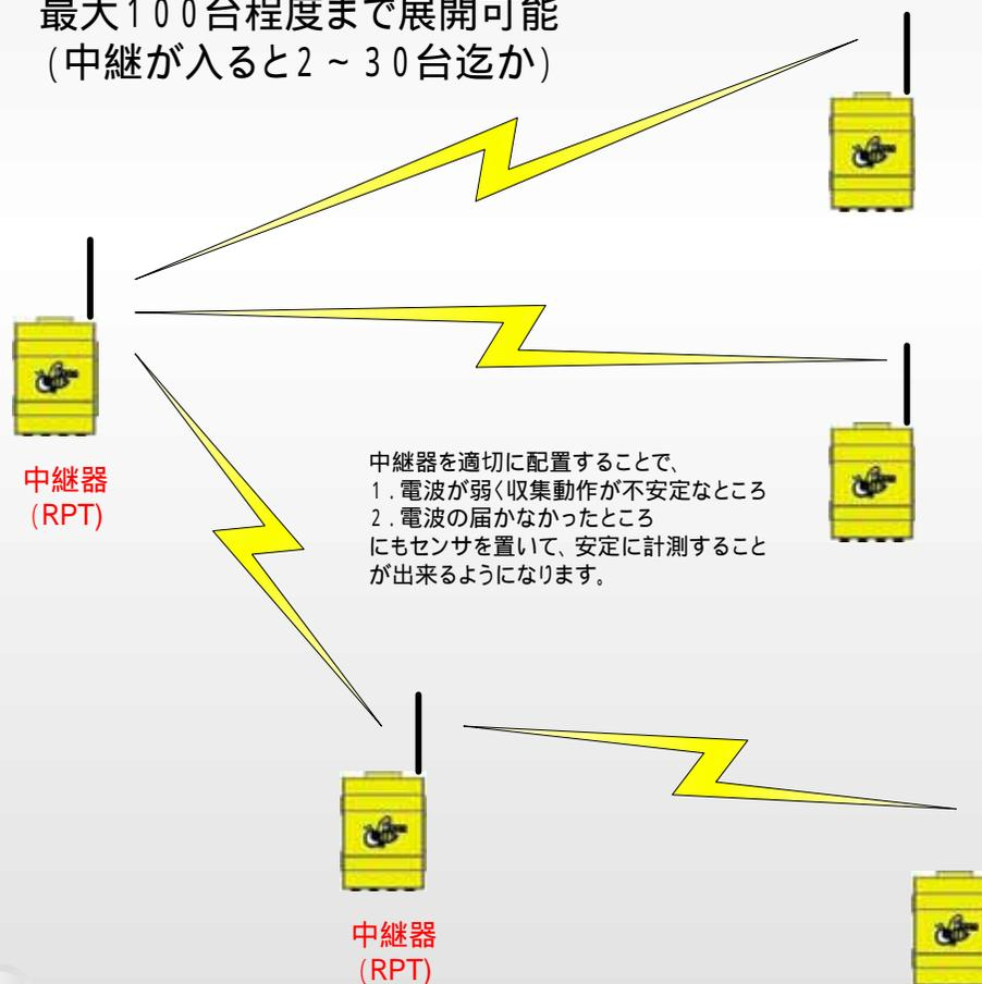
中継器 (RPT) は消費電力が大きいため商用電源での運用をお勧めします。
