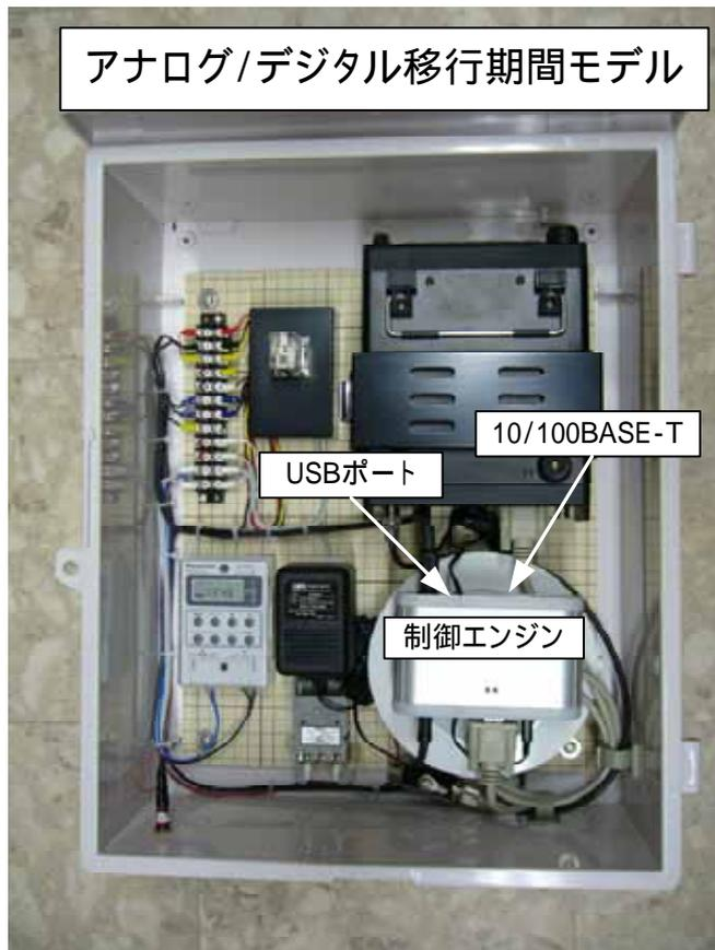
アナログ・モデルに、専用制御エンジン(IDデコーダ内蔵)を搭載したもので、このエンジンを追加することで、アナログ・モデルからバージョンアップできます。ただ、このエンジンのニーズは限定的なものという判断であり、デジタル型に移行する間の限定的なニーズにしばらくの間は、ご提供できるように準備をしておきます。
