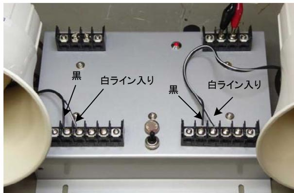
実際の設置には、本体とセットの屋外用スピーカーを接続して使用します(端子左端2:黒 端子3:白ライン入り)。
