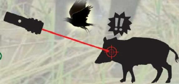
検出した害獣に向けて、自動追尾する威嚇装置（忌避手段）を制御して追い払いを行います
