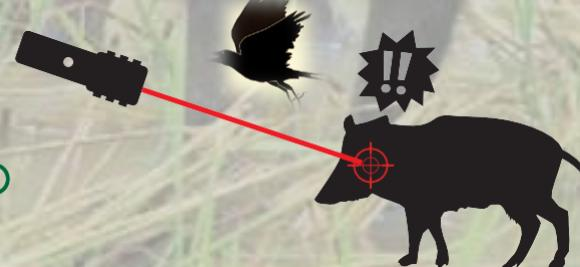
検出した害獣に向けて、自動追尾する威嚇装置（忌避手段）を制御して追い払いを行います
