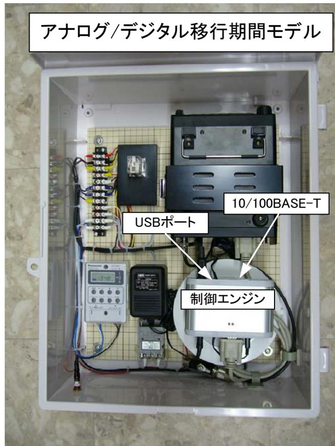
アナログ・モデルに、専用制御エンジン(IDデコーダ内蔵)を搭載したもののこのエンジンを追加することで、アナログ・モデルからバージョンアップできます。ただ、このエンジンのニーズは限定的なものという判断でおります(デジタル型に移行する間の限定的なニーズ)しばらくの間は、ご提供できるように準備をしておきます
